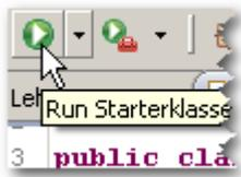
Mit einem Klick auf die Schaltfläche → Run wird die Anwendung kompiliert und ausgeführt.
